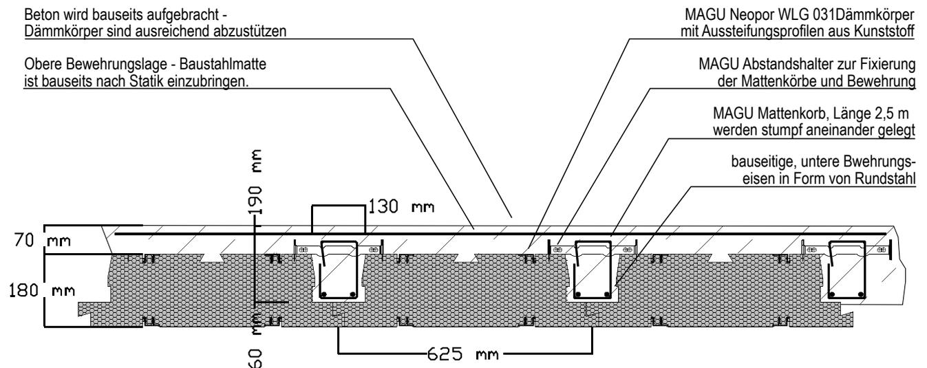
Die Stärke der Dämmkörper und der gesamten Decke, kann entsprechend den Anforderungen an den Wärmeschutz variiert werden. Statisch tragend ist der Mattenkorb in Verbindung mit der unteren- und der oberen Baustahl-Armierung. Auch diese kann individuell nach Ihren Vorgaben optimiert und kurzfristig bis Spannweiten von bis zu 12 m geliefert werden.
